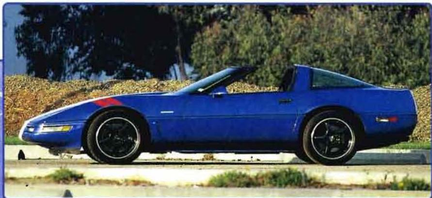
*На некоторые модели «Гранд Спорта» устанавливались дополнительные приспособления, позволявшие лучше проходить повороты на высоких скоростях. Это были более мощные стабилизаторы, более жесткие амортизаторы и пружины.*
