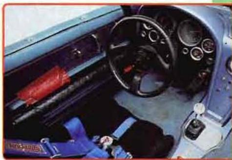
*Водительское сиденье в «БП Рейсере» оборудовано гоночными ремнями безопасности. Эти ремни, крепящиеся в пяти точках, обеспечивают водителю лучшую защиту при аварии на высокой скорости.*
