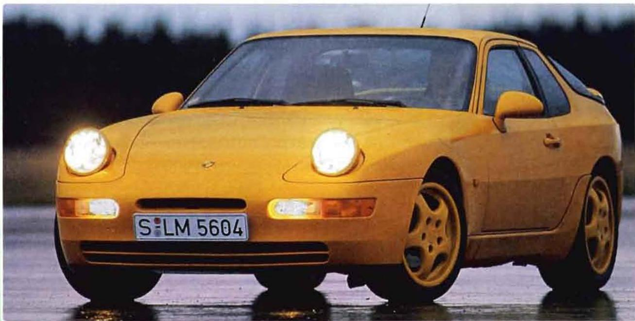
*Моделью «968» сможет хорошо управлять любой. Переднее расположение двигателя и заднее для коробки передач создает хороший баланс, и вы можете использовать всю силу 3-литрового 4-цилиндрового двигателя мощностью 240 л.с.*
