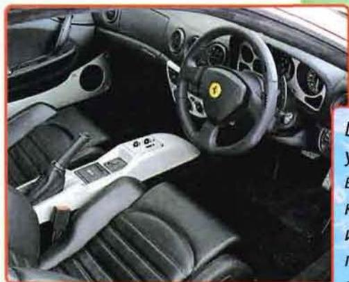
Широкие пластины, установленные возле рулевого колеса, используются для переключения передач в случае, если коробка передач F1 работает в ручном режиме.
