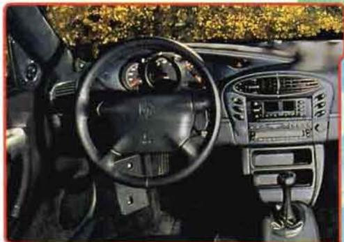
Приборная панель «Бокстера» современна и компактна. Спидометр и другие приборы иногда частично накрывают друг друга.
