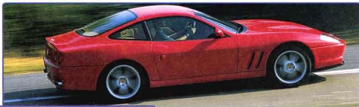
В конце 1990-х гг. «550 Маранелло» с 12-цилиндровым двигателем стал самым быстрым автомобилем «Феррари». Он разогнался до 100 км/ч за 4,4 секунды, а его максимальная скорость достигала 320,3 км/ч.
